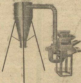
Rotor com martelos para secos. Disco de aço com facas para verdes. Fabricada com e sem cicloê.
