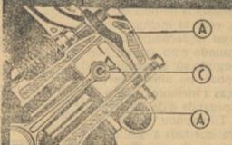
A) Camissa d'água, em toda e extensão dos cilindros e parte superior do carter, o que reduz o calor e resfria o óleo. B) Saída de água no centro dos cabeçotes, e novas bombas d'água na parte inferior do bloco, asseguram mais eficiente circulação e arrefecimento. C) Novos pistões, de uma liga de aço especial, que asseguram ajuste mais perfeito, aumentando, consideravelmente, a vida dos cilindros e anéis e reduzindo o consumo de óleo.
