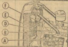
D) Dupla correia de ventilador, para maior durabilidade. Novas bombas d'água, que, com lubrificação permanente, não exigem a minima attenção. E) Dispositivo especial, que proporciona melhor circulação de ar, através do radiador. F) Gerador com ventilador embutido, que protege o gerador contra calor excessivo, aumentando a sua eficiencia. G) Entrada do ar para o ventilador do carter.
